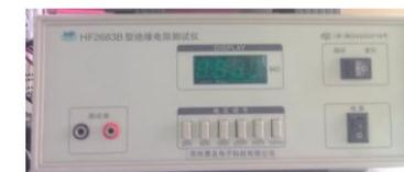
器件材料绝缘电阻测试仪
